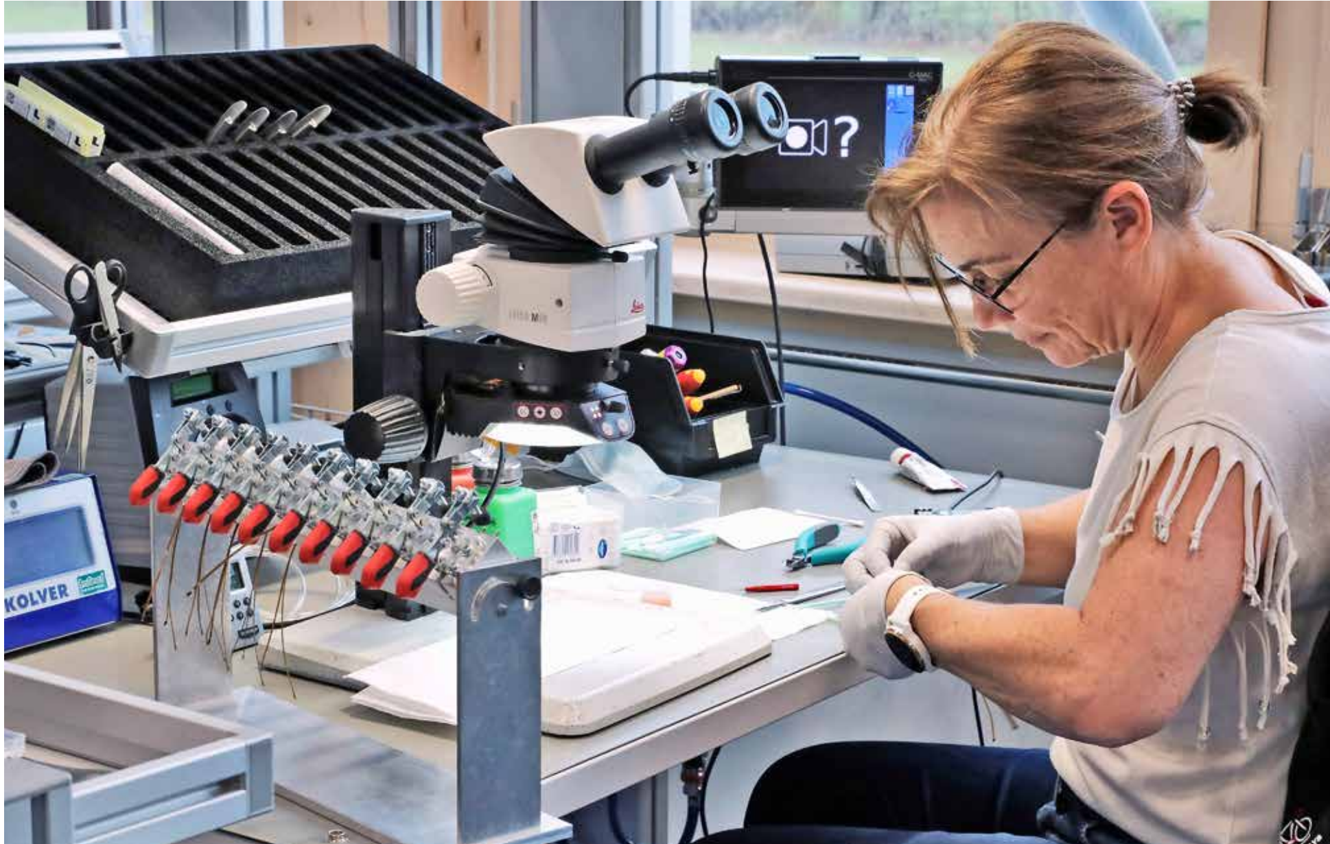
Zusammensetzen, befestigen, löten – für viele Produkte der Brütsch Elektronik AG braucht es eine sorgfältige Montage. Feinmotorik für Arbeiten unter dem Mikroskop und Konzentration auf kleinste Teile gehören zum Arbeitsalltag dazu. BILDER RAMONA MELIS
